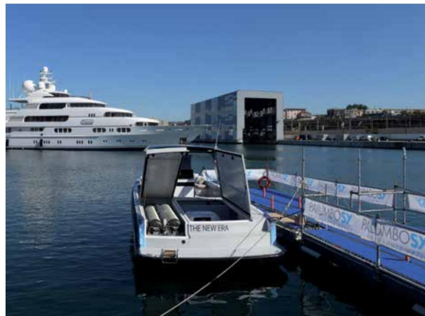
Hynova, bateau à propulsion hydrogène.
